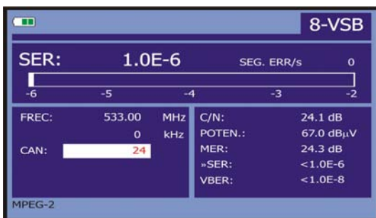
Figura 37.- Pantalla de medida del SER de señales moduladas en 8-VSB .
