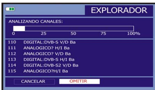
Figura 18.- Pantalla de exploración del espectro. EXPLORER.
