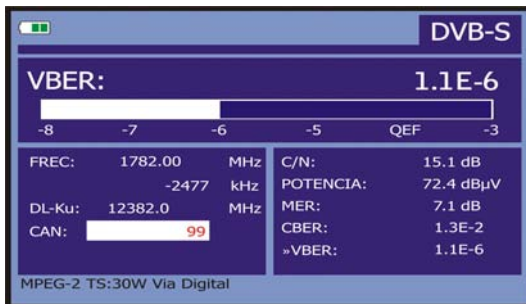
Figura 40.- Pantalla de medida del VBER de señales moduladas en QPSK . (DVB-S).
