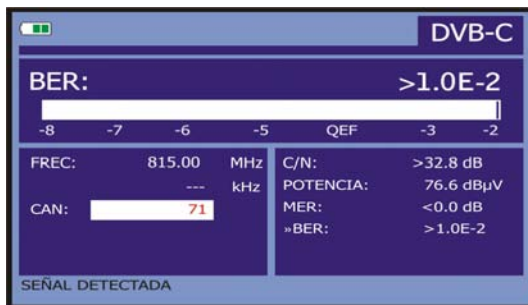
Figura 33.- Pantalla de medida del BER de señales moduladas en QAM .
