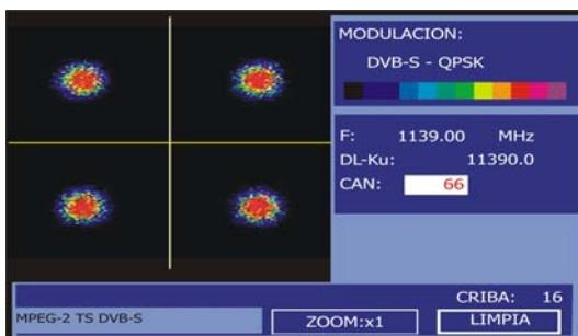
Figura 48.- Diagrama de constelación. Señal DVB-S (QPSK).
