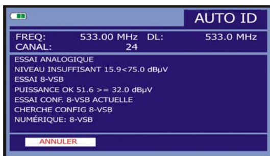
Figure 9.- Écran d'identification automatique de signaux. AUTO ID .
