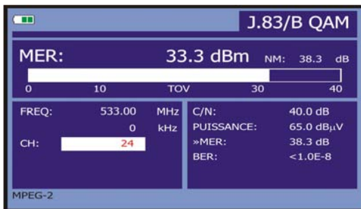
Figure 31.- Écran de mesure du BER de signaux modulés en QAM Annex-B .
