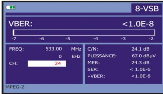
Figure 36.- Écran de mesure du BER de signaux modulés en 8-VSB. VBBER.
