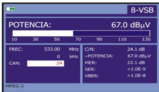
Figura 30.- Medida de la potencia de canales digitales.
