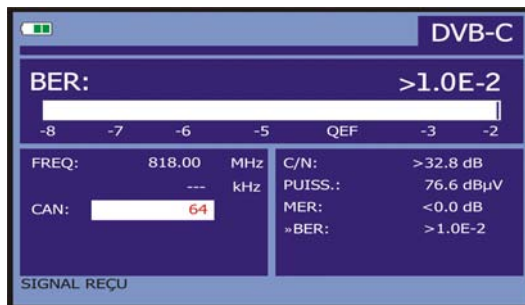
Figure 33.- Écran de mesure du BER de signaux modulés en QAM .
