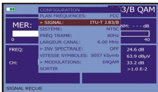
Figure 20.- Écran de configuration des mesures de signaux modulés en QAM Annex-B .
