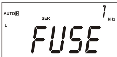
Figura 6.- Detección del estado del fusible.
